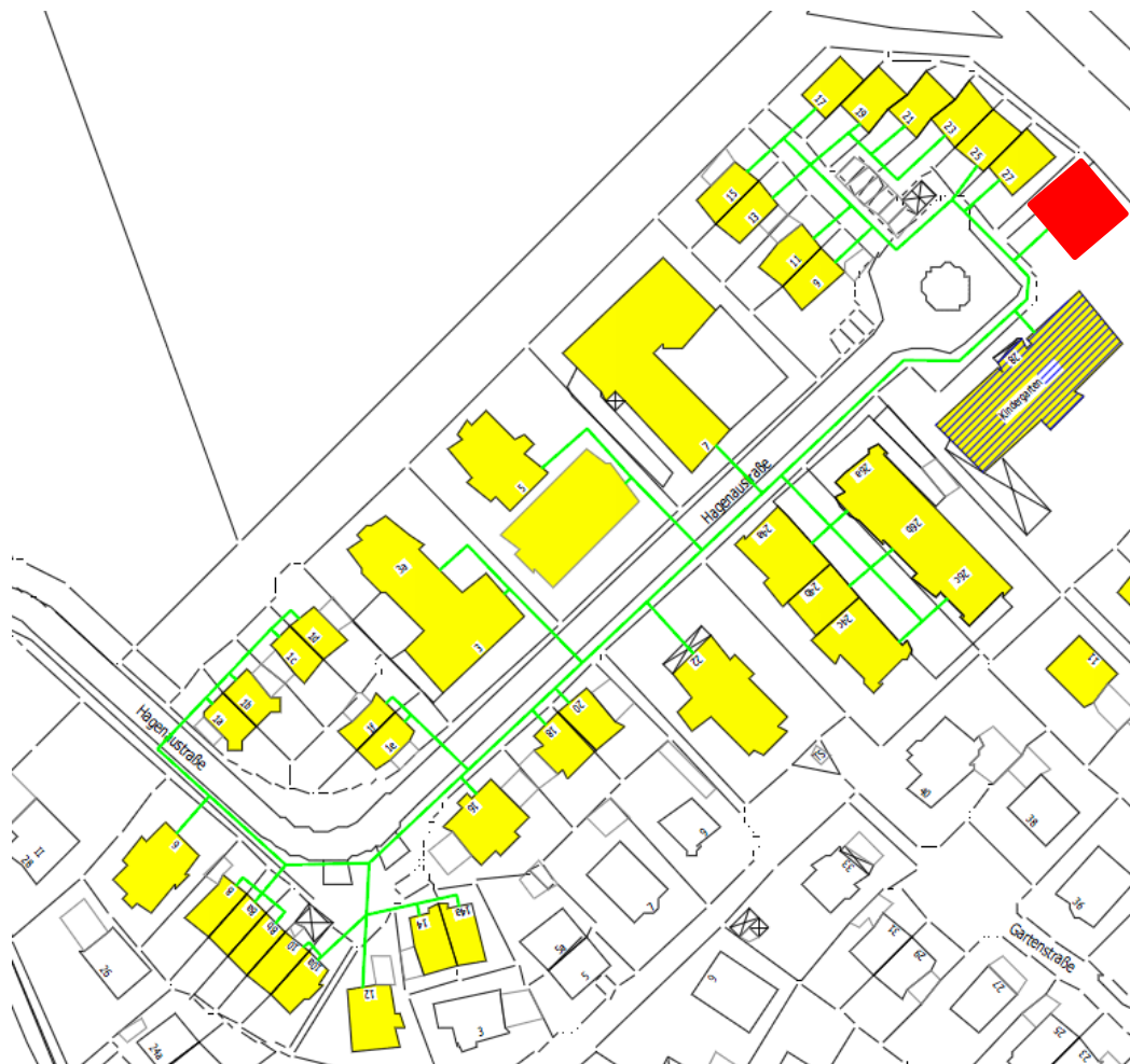
Abbildung 28: Der potentielle Netzverlauf des Nahwärmeverbunds 1
