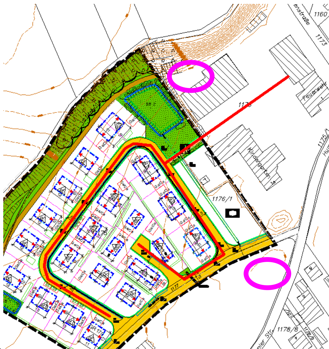
Abbildung 44: Der potentielle Netzverlauf des Nahwärmeverbunds 2, Langenbach Nieder-/Oberhummel
